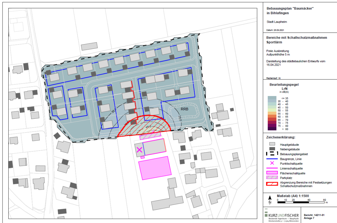
Bereiche mit Schallschutzmaßnahmen, Kurz und Fischer GmbH, 2021
